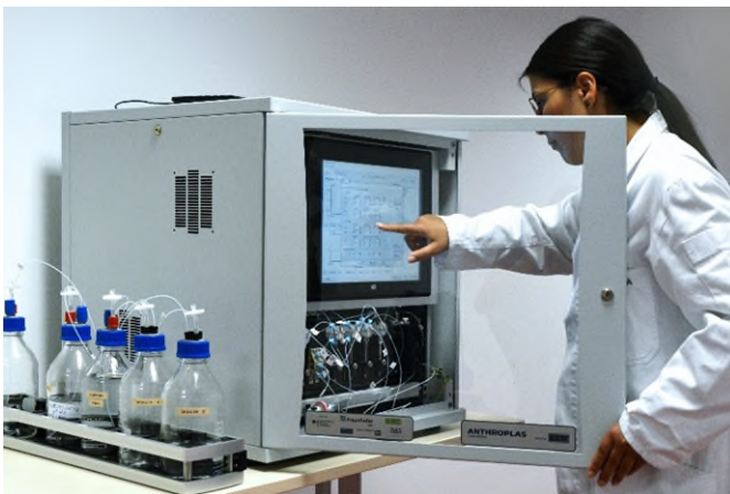
Abb. 2 Optisches Sensorsystem, das Mikroschadstoffe im Abwasser nachweist und somit Reinigungsprozesse zukünftig bedarfsgerecht steuern kann.
